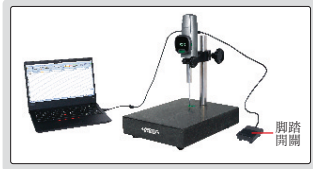
無需安裝軟件，數據可傳輸到Excel； 短按腳踏開關采集數據，長按置零
