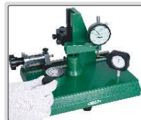
檢測針盤式量表的測力
