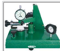
檢測針盤式量表的重復性
