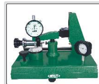
檢測徑向力對針盤式量表數值的影響 (需選配半圓量塊)
