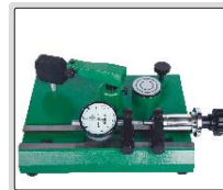
檢驗針盤式量表的精度 (測定範圍0-25mm)
